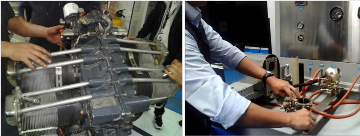
Fotografía No. 3: Inspección post-accidente al motor (izq.) y carburador (der.)
